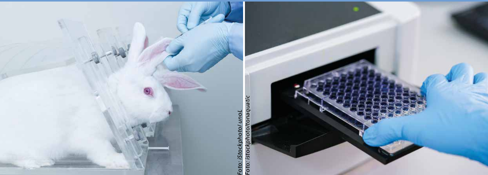
Mit derartigen Mikrotiterplatten werden tierfreie Tests durchgeführt.
