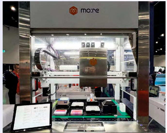
MO:BOT auf einer Messe mit einem Tablet, auf dem die Software zum Planen und Durchführen von 3D-Zellkultur-Experimenten zu sehen ist.
